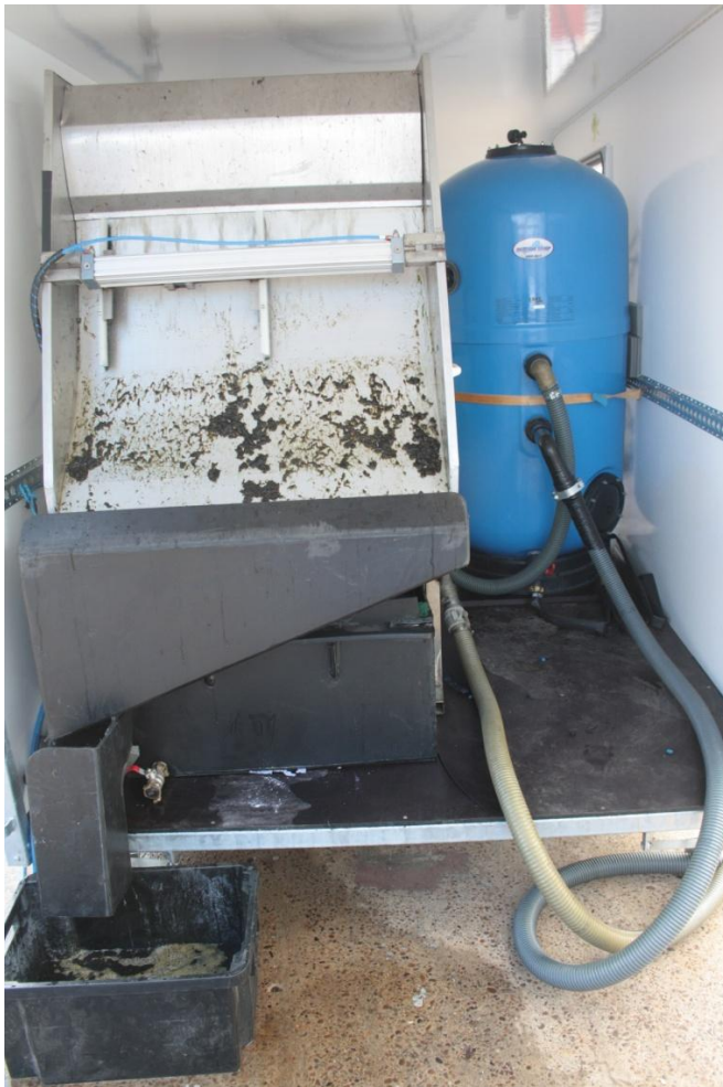
Abb. 1: Filtrationsvorrichtung mit Siebfilter (100 µm), darunter Vliesfilter 100 µm und Feinfilter (100 µm) mit abführendem grauen Schlauch, über den das filtrierte Wasser in das Hafenbecken zurückgeleitet wurde
