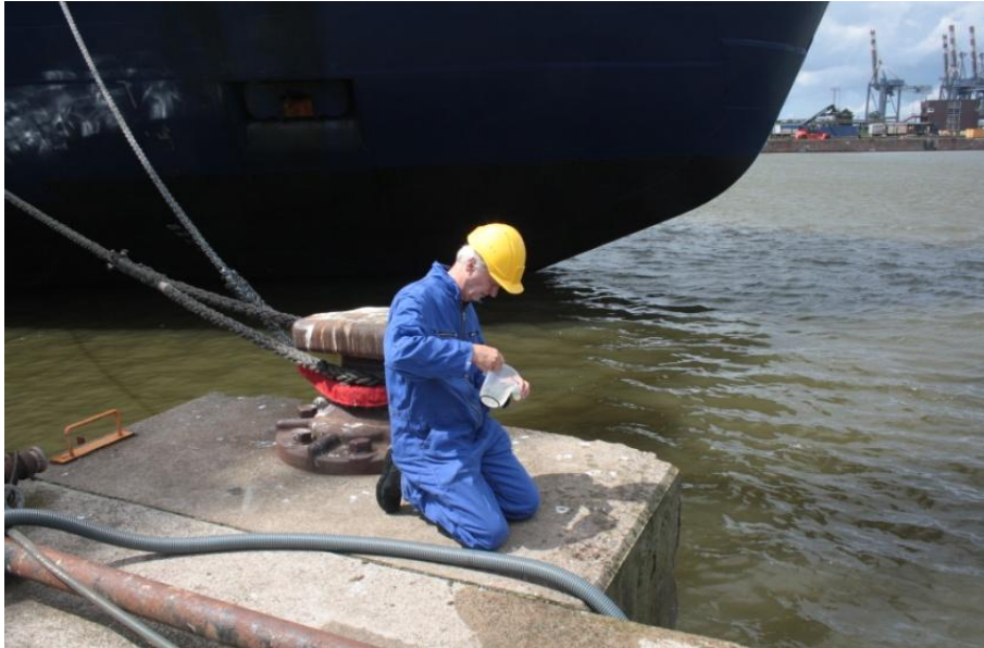
Abb. 2: Entnahme der filtrierte Wasserproben aus dem abführenden Schlauch der Filtrationsvorrichtung
